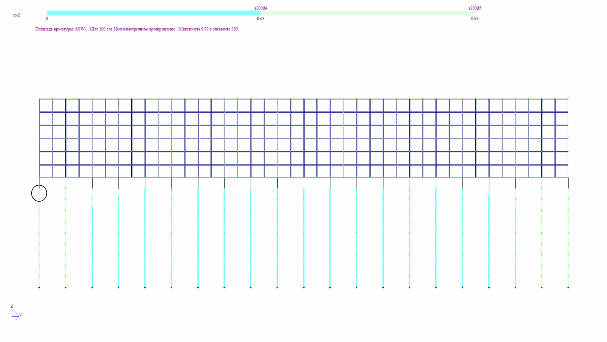
Рис. 7.3. Поперечное армирование сваи
